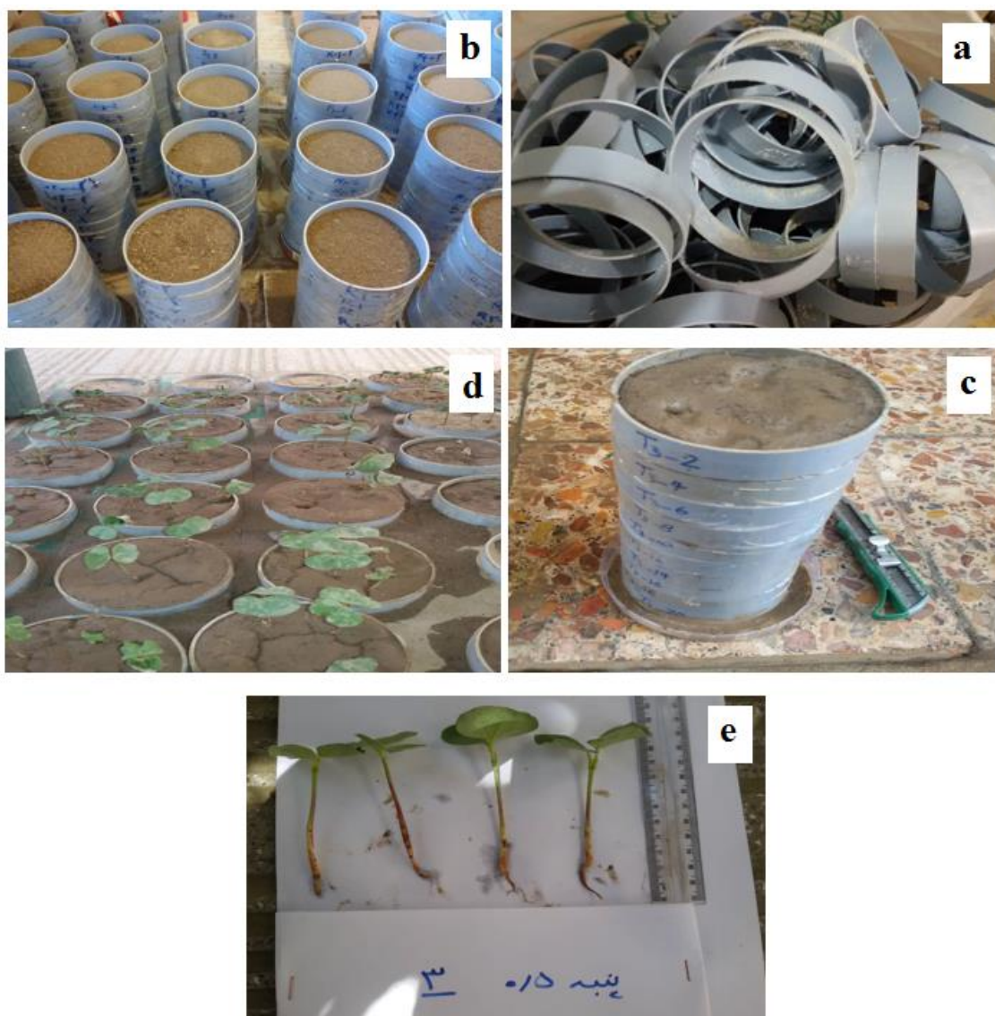
شکل ۱- مراحل انجام آزمایش آبشویی؛ (a) برش دهی لوله، (b) چسباندن لوله‌ها و پر کردن با خاک، (c) آبیاری، (d) کاشت بذور پنبه و (e) اندازه‌گیری صفات
