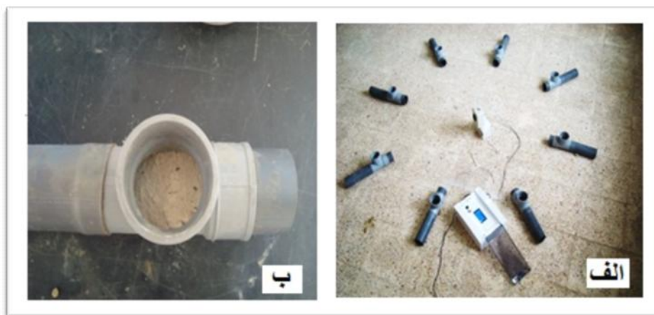
شکل ۲- الف) چیدمان لوله‌های آزمایش به همراه دستگاه تولید امواج آلتراسونیک ب) آرد و شیشه قرمز درون لوله آزمایش Figure 2- a) Exposure of test tube and wave generator b) Fluor and Tribolium castaneum in experimental tube
