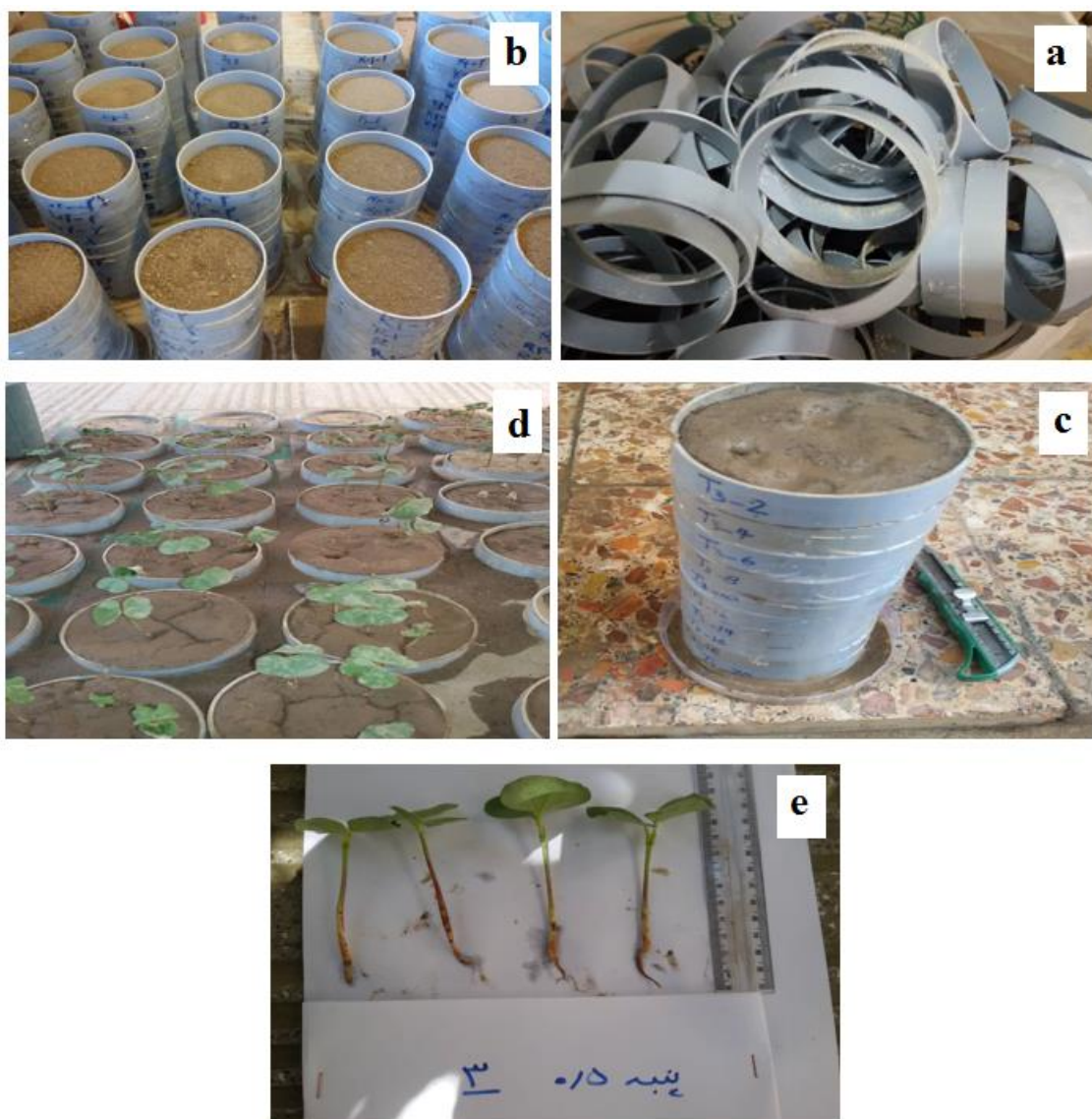
شکل ۱- مراحل انجام آزمایش آیشویی؛ (a) برش دهی لوله، (b) چسباندن لوله‌ها و پرکردن با خاک، (c) آبیاری، (d) کاشت بذور پنبه و (e) اندازه‌گیری صفات
